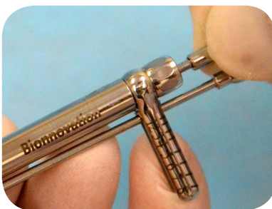
8- Solte o parafuso de fixação até o fim e puxe a Haste eixo para iniciar a desmontagem do torquímetro.
