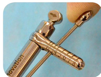
6- Conduzir a haste flexível ao número indicador desejado na régua de leitura . A régua varia de 1 a 8 sendo que o valor do torque será o número indicador multiplicado por 10.Exemplo: Se o Torque desejado for de 30N, a haste deverá ser conduzida até o número 3.
