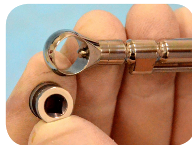
9- Para remover a catraca puxe a haste eixo.
