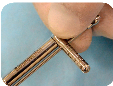
5- A Régua de leitura auxiliará o profissional a visualizar o torque a ser aplicado ao implante /componente.
